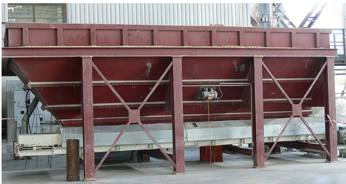
Бункер для песка с вибратором и нижним транспортером выдачи на заводе газобетона (рабочее состояние)
