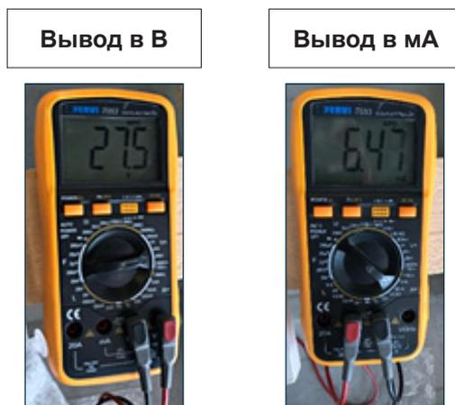
Если значение напряжения находится в пределах от 3 до 24 В, а значение тока равняется приблизительно 4 мА с отсоединенными трубками, то электронная плата работает нормально.
