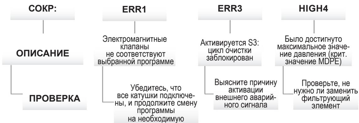
Вывод WK служит для подачи аварийного сигнала, когда срабатывает один из датчиков ERR1, ERR3 или HIGH4. В активном состоянии на дисплее отображается окно "ALARM".
